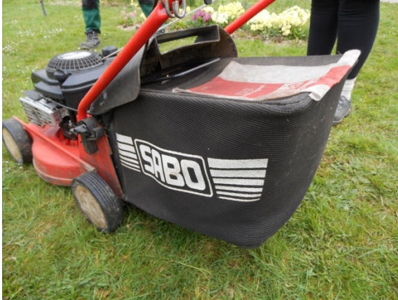
Das Einsetzen des Auffangkorbes
