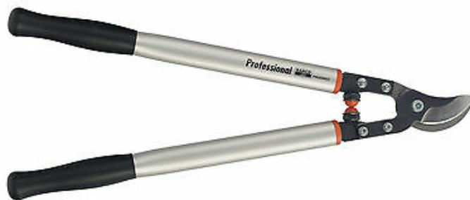
Der Astkneifer wird auch Astschere genannt. Er hat zwei Haltegriffe eine Klinge und eine Gegenklinge (Amboss).
